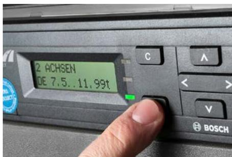
Im Fahrzeuggerät ist grundsätzlich das zulässige Gesamtgewicht dauerhaft gespeichert, das der Kunde bei der Registrierung des Fahrzeugs angegeben hat. Ändert es sich, weil ein Anhänger an- oder abgekoppelt wird, ist vor Antritt der Fahrt das zulässige Gesamtgewicht auf der OBU anzupassen. Nach einem Zündwechsel wird immer die Gewichtsklasse der letzten Fahrt angezeigt.
